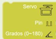
Mueve un servo indicando la posición deseada en grados. **Debes esperar al menos 20ms** antes de volver a usar esta instrucción. **Conecta el servo al pin A3.**
