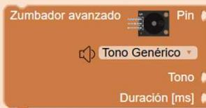
Crea sonidos variados que se modifiquen en función de ciertas condiciones (p.e. la distancia del sensor de ultrasonidos). **El zumbador está conectado al pin D5.**
