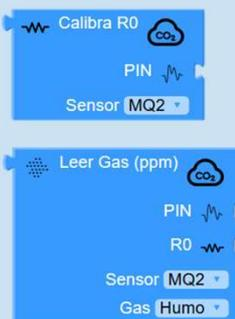
Detecta muchos tipos de gases con los sensores MQx. **Calibra el sensor** para un funcionamiento correcto y después, obtén **lecturas del gas calibradas en ppm.** **Conecta el sensor al pin A3.**
