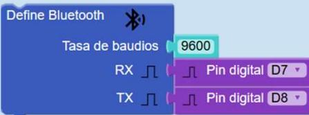
Define la comunicación bluetooth. Necesitas indicar los pines a los que están conectados los pines RX y TX del módulo bluetooth. **Baudios = 9600. Esta líneas van cruzadas. Conecta TX a D7 y RX a D8.**
