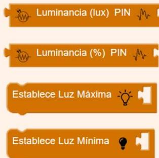
Obtén valores calibrados de luminancia con un sensor de luz LDR en luxes. **Establece valores máximos o mínimos** en luxes que esperas recibir para calcular la luz como un porcentaje. **Este sensor está conectado al pin A1.**
